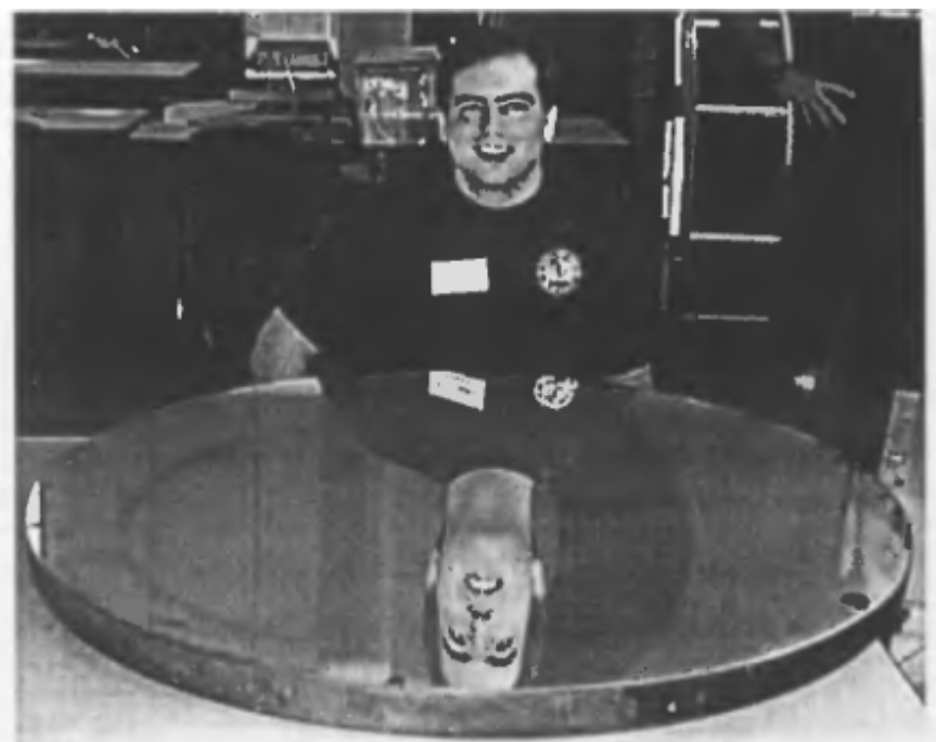
Рис. В.1. Да оно большое! Дэн Бэккен на дано фото показан с 41-дюймовым f/4 зеркалом, которое он обработал, сформировал и отполировал вручную — с помощью друзей. Данное зеркало используется в большом каркасном телескопе, который Дэн зовет «Геркулес».
