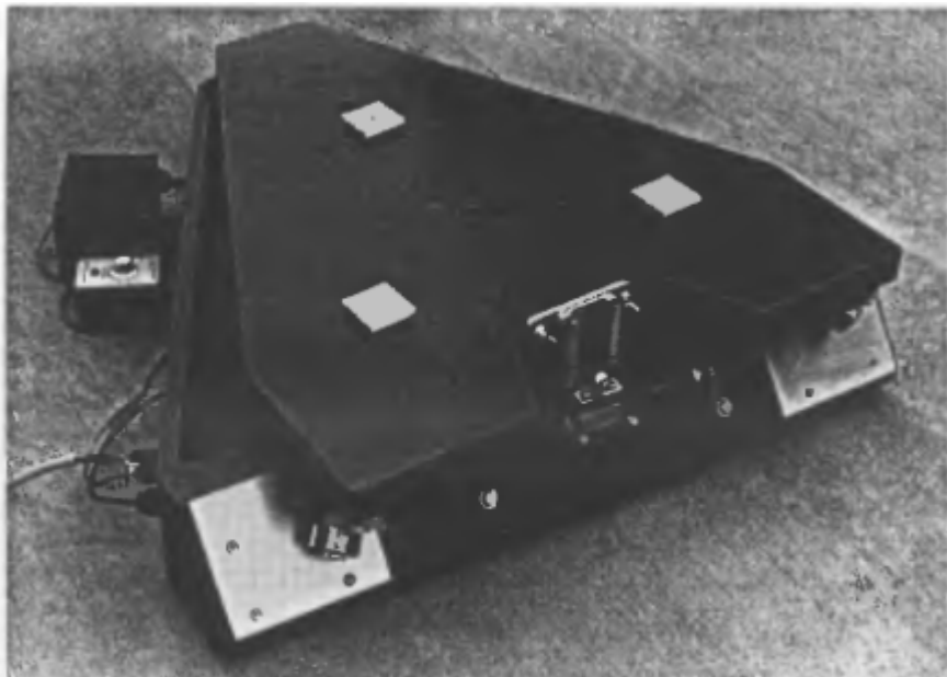
Рис.D.1. Том Мартинес построил одну из первых экваториальных платформ, которая была достаточно крепкой, чтобы выдержать вес большого Добсона. Однако, поскольку двигающие ролики были установлены под наклоном, тяжелая нагрузка слегка сбила платформу.
