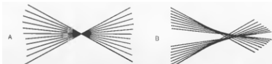
Рис. В.5. Звездный тест показывает, как свет от зеркала проходит через фокус. В превосходном зеркале (А) вы видите равномерное распределение света на внутреннем и внешнем фокусе. В зеркале со сферической aberrацией (В), распространение света меняется со сменой фокуса. Дифракционные круги упрощенно показаны на этой картинке.
